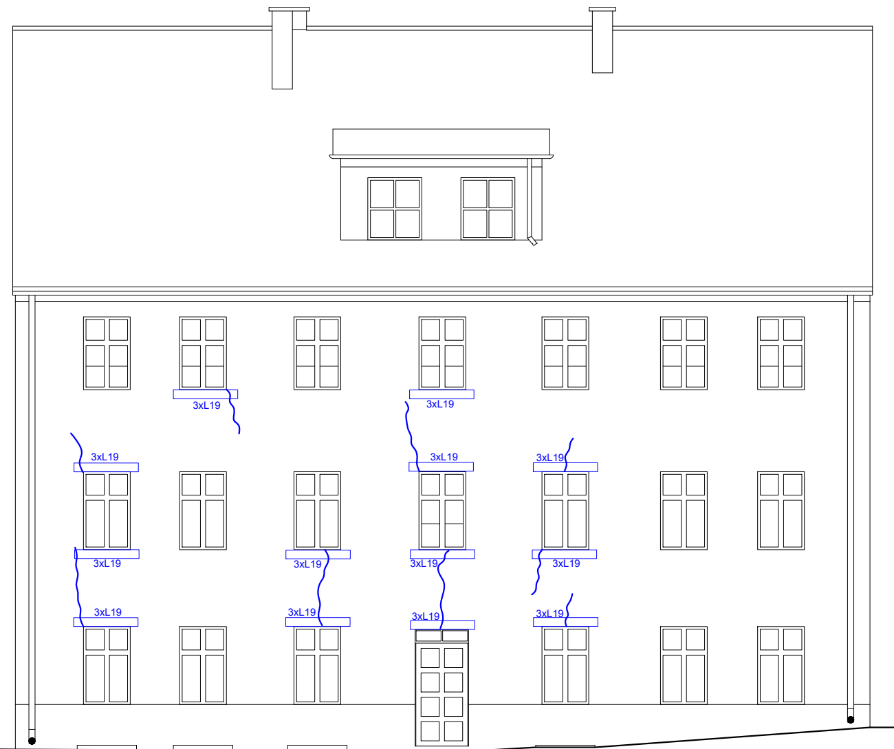
ELEWACJA FRONTOWA – ELEMENTY DO WZMOCNIENIA
