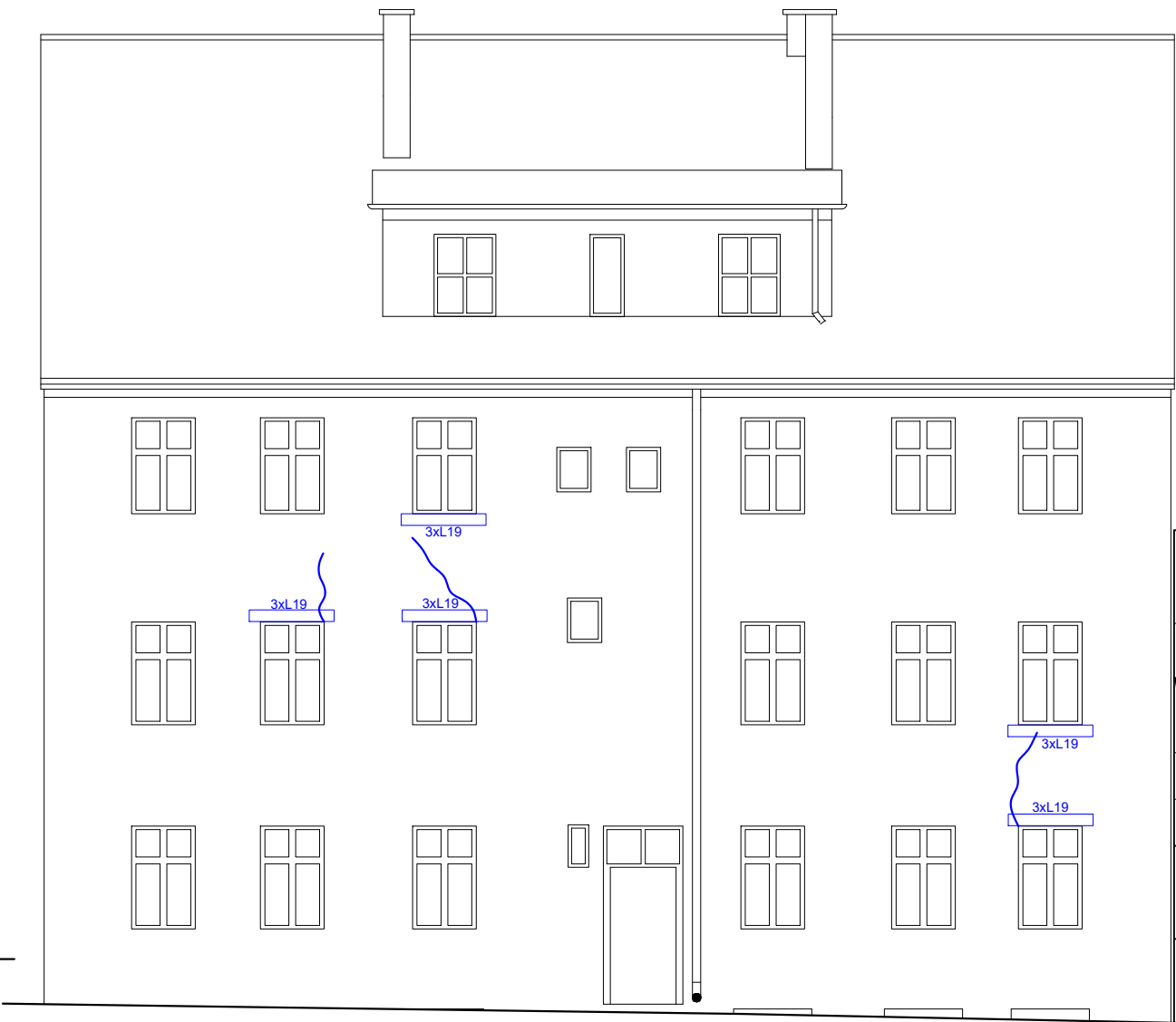
ELEWACJA TYLNA – ELEMENTY DO WZMOCNIENIA
